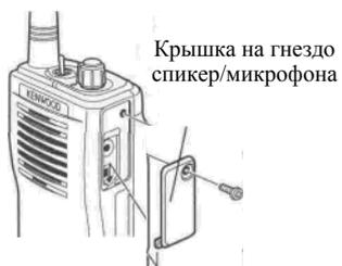
Если Вы не используете спикер/микрофон, установите крышку на его гнездо, используя винты 3х6 мм.
