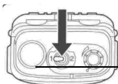
Установите переключатель каналов для выбора желаемого канала.
